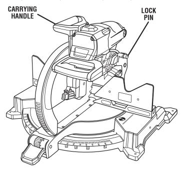
SAW ARM LOCKED IN DOWN POSITION
